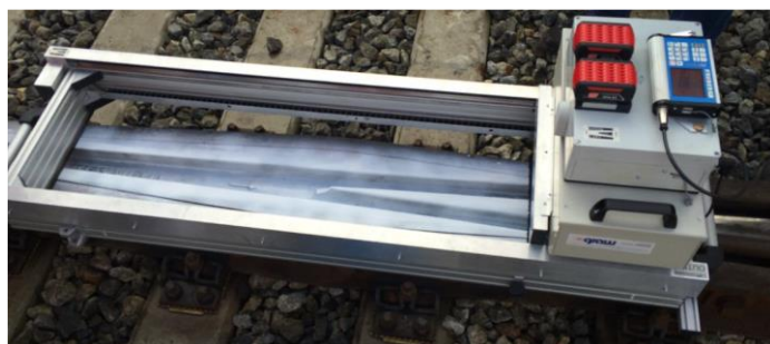
5. Pomiar skanerem 3D Skorpion krzyżownicy w rozjeździe z PPP na stacji Siedlce, luty 2016
