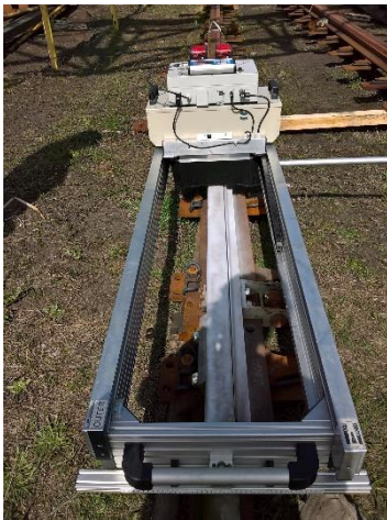
7. Pomiar skanerem Skorpion nowej iglicy w Track Tec Koltram Zawadzkie, kwiecień 2016
